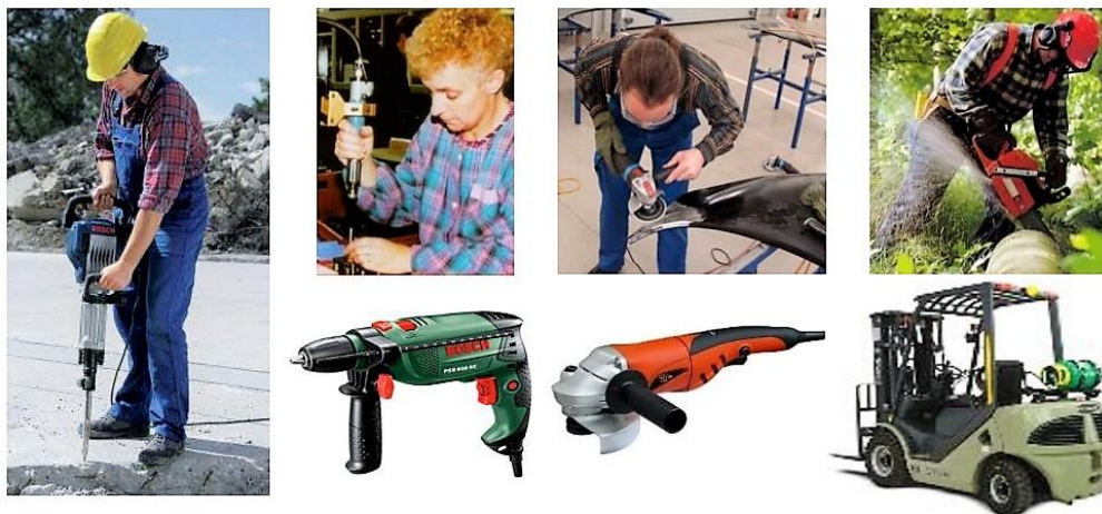
Rys. 9. Typowe źródła drgań mechanicznych (od lewej: młot pneumatyczny, ubijak, szlifierka, piła łańcuchowa; u dołu: wiertarka udarowa, szlifierka kątowna, wózek widłowy) [4i]
