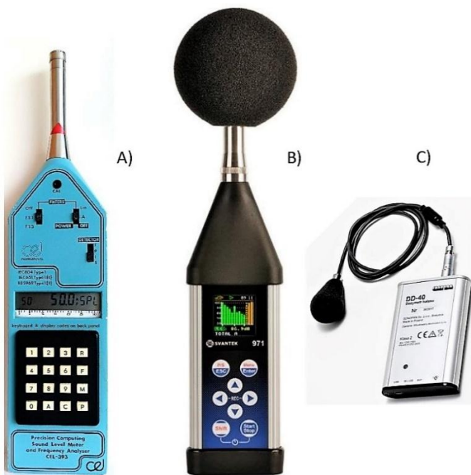
Rys. 20. Całkujące mierniki poziomu dźwięku: CEL starszej konstrukcji (A) (fot. E. Tytyk), nowy, Svantek (B) i dozymetr, Sonopan (C) [11i]
