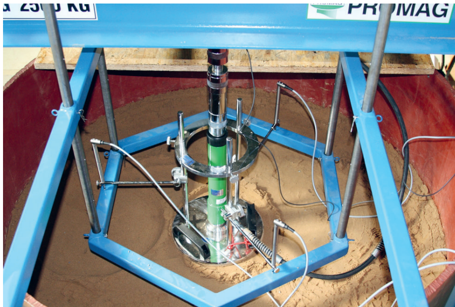
Rys. 15. Stanowisko badawcze wraz z aparaturą do oceny nośności i zagęszczenia wielkowymiarowych modeli podtorza kolejowego [22]
