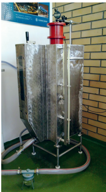
Fot. 8. Aparat do badania sufozyjności gruntów
