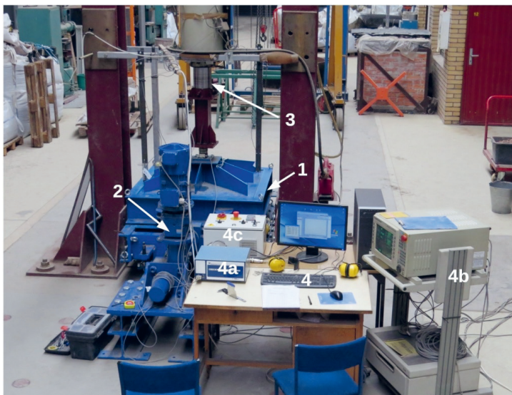
Fot. 3. Widok WABS od strony stanowiska sterowania na pozycji badania: 1 – skrzynia aparatu na pozycji badania, 2 – napęd stanowiska, 3 – siłownik hydrauliczny do zadawania obciążeń pionowych, 4 – stanowisko sterowania, 4a – GEODATALOG, 4b – sterownik prasy Schenck, 4c – sterownik napędu stanowiska
