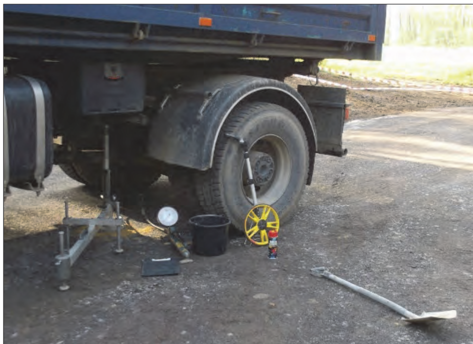
Rys. 1. Pomiary nośności statyczną płytą sztywną – aparatura badawcza
