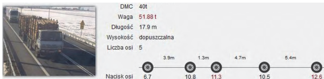
Rys. 4. Obciążenie poszczególnych osi wyznaczone podczas pomiaru preselekcyjnego (na podstawie [35])
