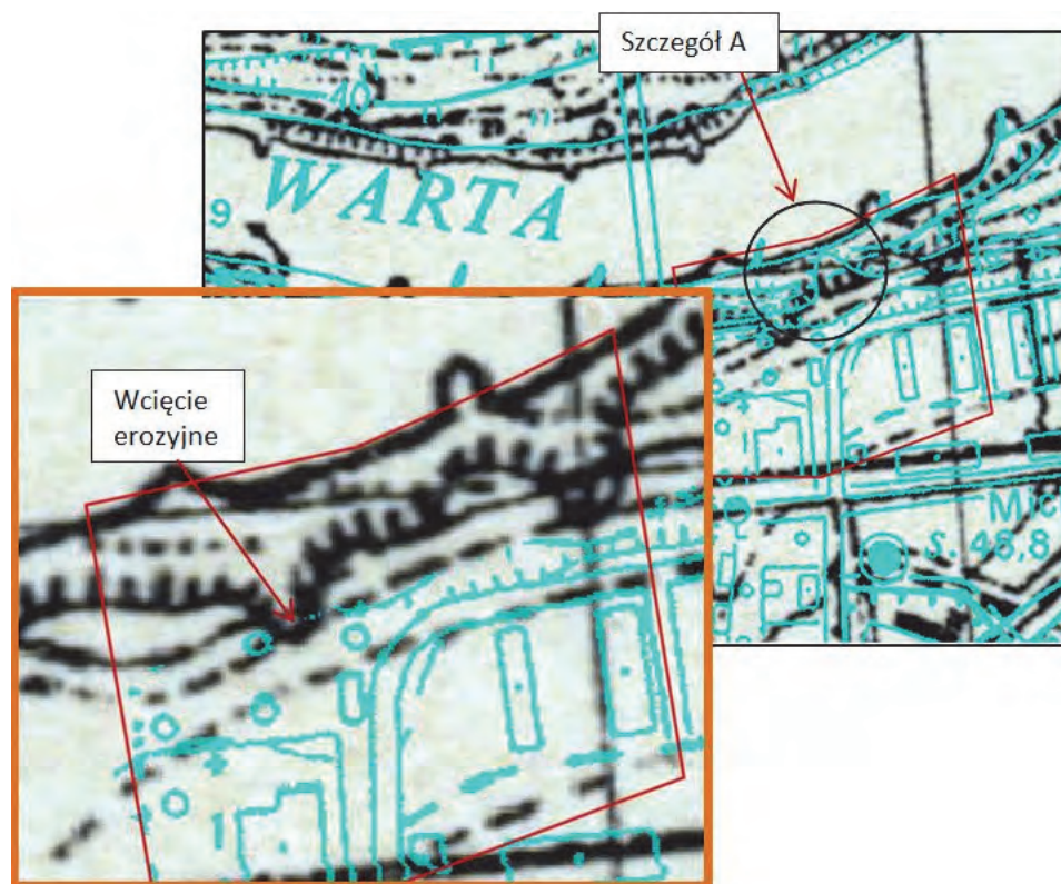
Rys. 23. Mapa topograficzna 1931 r. (kolor czarny) nałożona na aktualną mapę topograficzną (kolor niebieski). Szczegół A – fragment odkrytej mapy topograficznej
