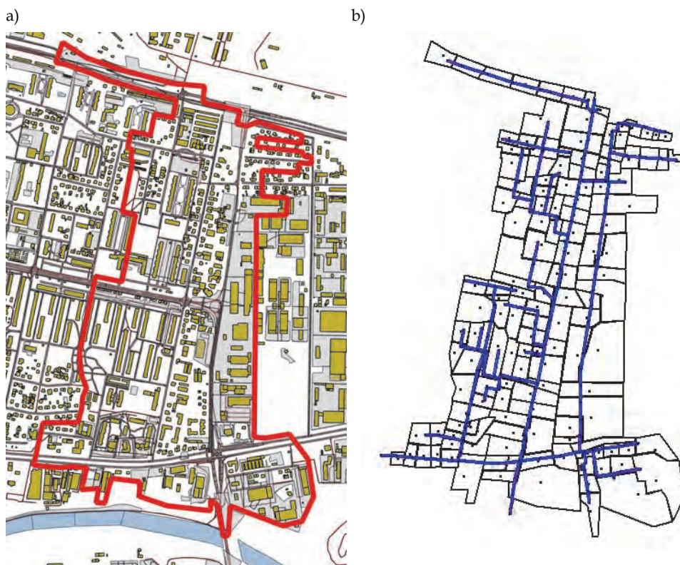
Rys. 2. Zagospodarowanie zlewni (a) oraz schemat jej odwzorowania w modelu (b)
