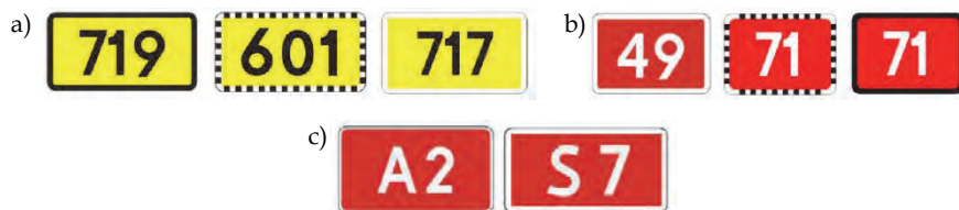
Rys. 1. Oznaczenia nośności nawierzchni na znakach kierunku i miejscowości [19]: a) drogi wojewódzkie b) drogi krajowe c) autostrady i drogi ekspresowe
