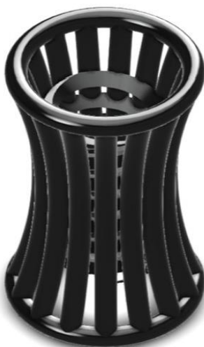
Rysunek 1. Model nośnika wytworzonego techniką druku 3D wykorzystanego do immobilizacji enzymów.
