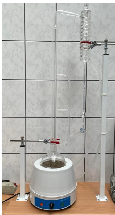
Rysunek 1. Stanowisko eksperymentalne do otrzymywania olejków eterycznych – aparat Derynga.
