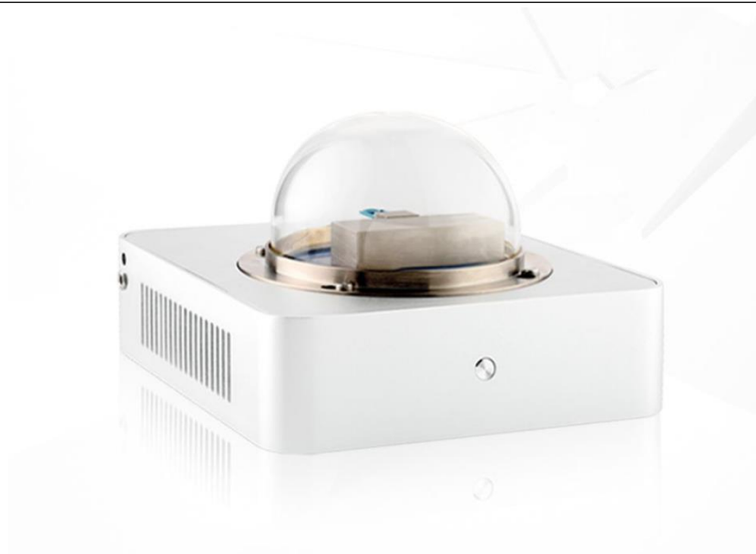
Rys. 2 Opatentowane rozwiązanie pomiarowe dla badań tworzyw i innych materiałów dla analizy przemian fazowych, zaindukowanego czasu utleniania, badań czystości, kinetyki i identyfikacji tworzyw – metodą DSC.
