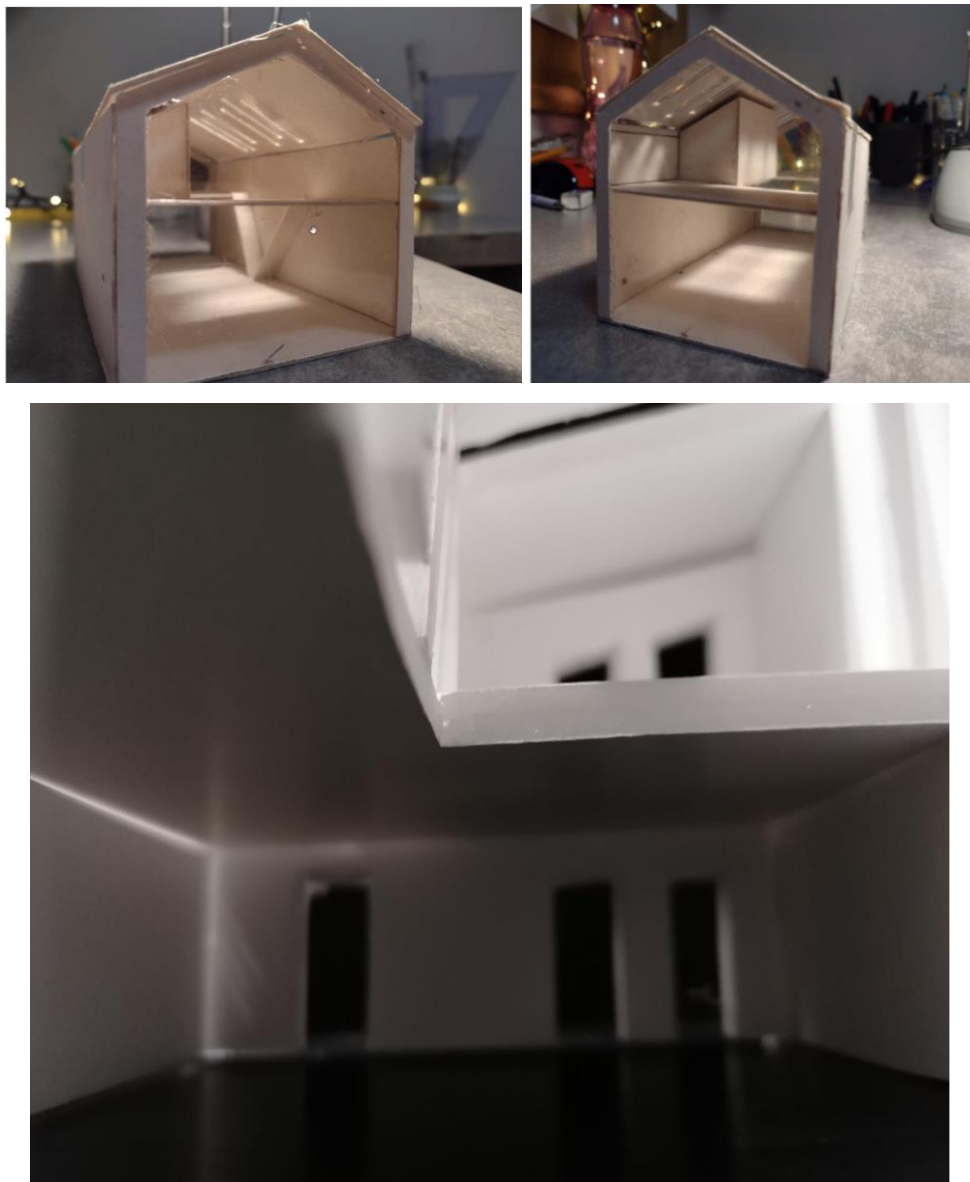
Rys. 15. Przykład makiety roboczej wykonanej przez studenta i analiza doświetlenia wnętrza
