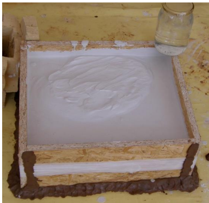
Ryc. 6. Prototyp modułu zalany gipsem ceramicznym – forma negatywowa (część zewnętrzna)
