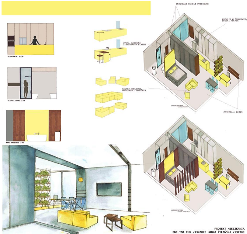
Rys. 3. Projekt mieszkania z elementami ruchomymi (kinetycznymi) we wnętrzu, które wydzielają przestrzenie sypialni i łazienki. Projekt autorstwa E. Zub i H. Żylińskiej pod kierunkiem A. Bonenberg
